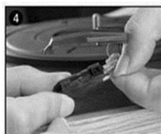
Remover la línea de audio del cartucho
